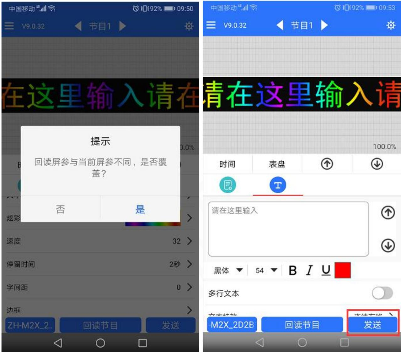
如果是第一次使用，需要修改显示屏的基本参数，如：选择单元板、高度、宽度等，点击最下边发送。（建议选择自动扫描走线，更改扫描模式——点击开始——观察屏幕显示，显示正常后点击停止）发送成功后屏幕显示控制卡型号、版本号等信息。
