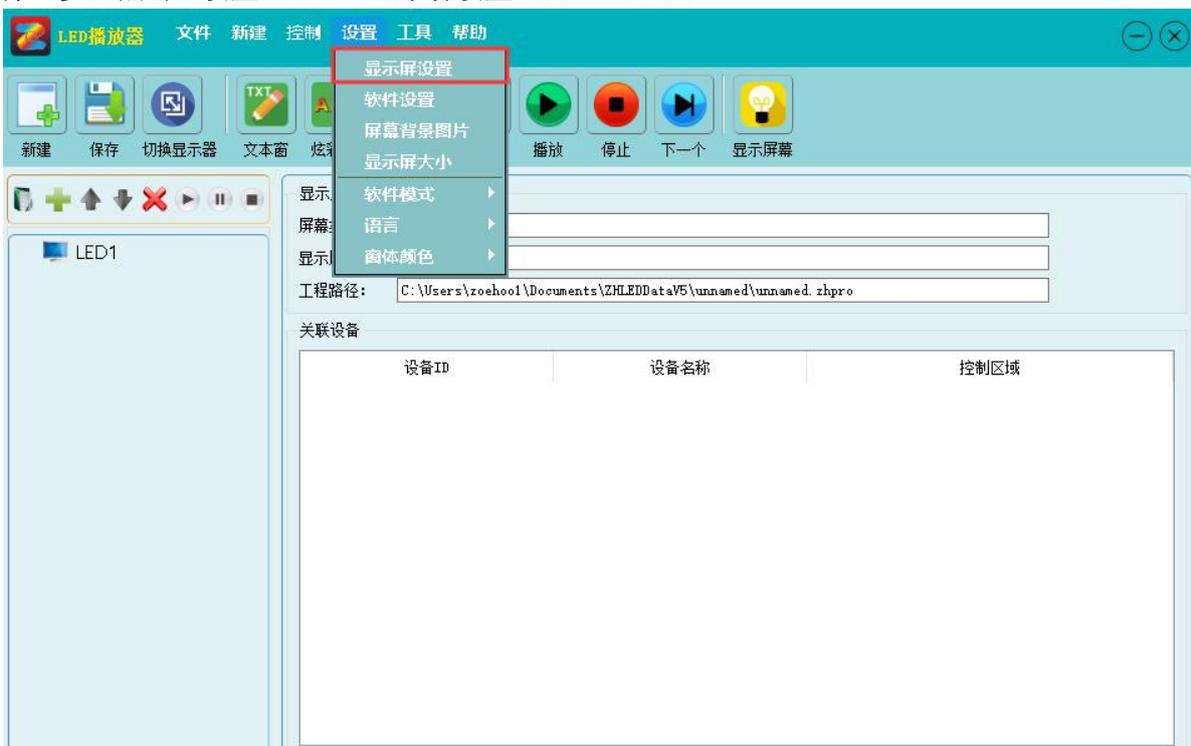
第三步：选择“发送卡”，显示红框内容的信息即为寻机成功，点击“显示屏设置”，输入密码“168”。
