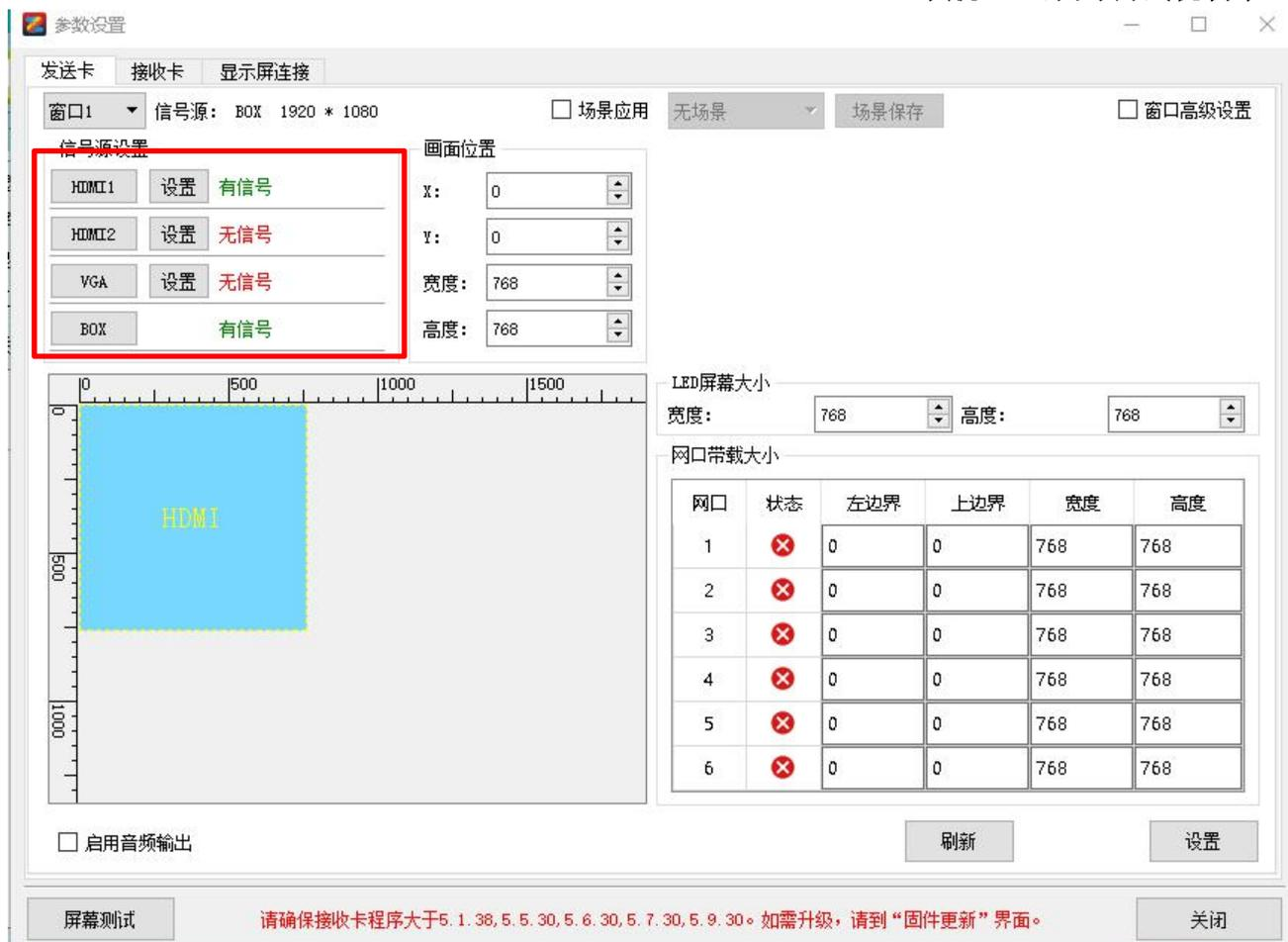
第五步: 如果单元板信息已知, 可直接用“选择模组”的方式调试(也可使用“智能设置”), 设置“高度”、“宽度”后点击“发送到硬件”、“保存到硬件”。
