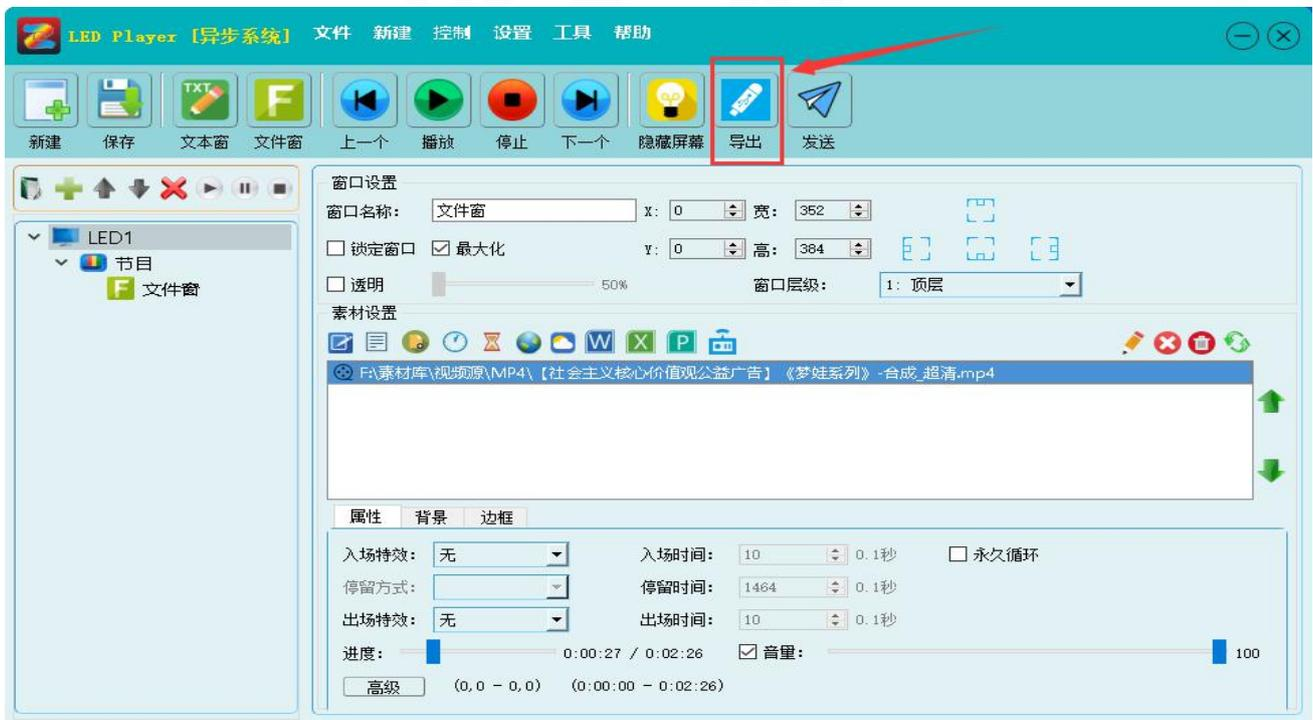
2) 进入“导出 U 盘”，如果添加的有时间，请勾选“时间校准”复选框，最后点击“导出”。
