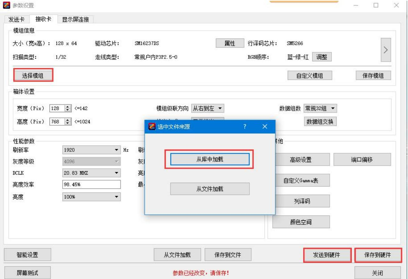
第六步：左上角选择“显示屏连接”，设置“接收卡列数”、“接收卡行数”、“接收卡大小”后，将网线连接顺序正确连接，（在此处，只需记住一点，正面看 LED 屏和正面看电脑是一个方向，分清上下左右即可）。配置完成以后，点击“发送到硬件”，屏幕正常显示后点击“保存到硬件”，调试完成。
